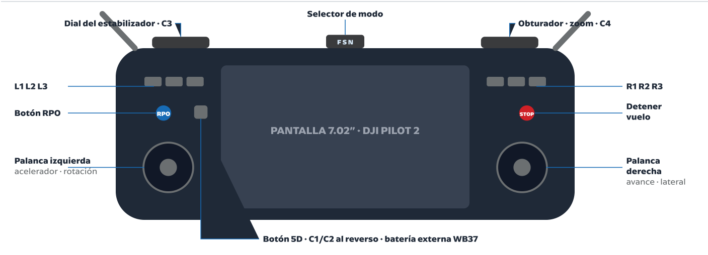
FIG. 3.2 · RC PLUS 2 ENTERPRISE, VISTA FRONTAL ESQUEMÁTICA EN MODO 2 (POSICIONES APROXIMADAS; CONSULTA EL MANUAL DE DJI)
