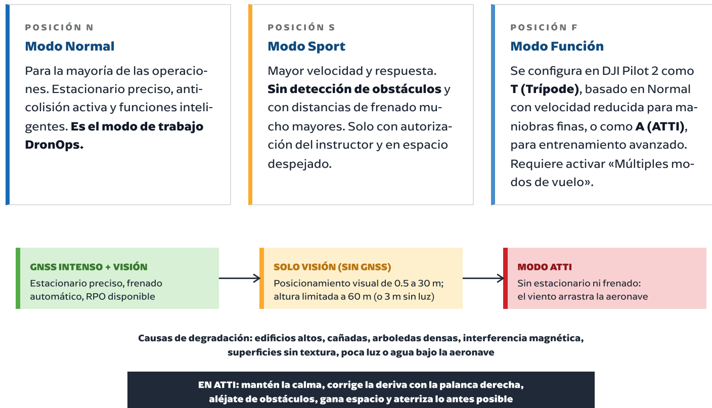
FIG. 3.3 · DEL POSICIONAMIENTO DISPONIBLE DEPENDE EL COMPORTAMIENTO REAL DE LA AERONAVE
